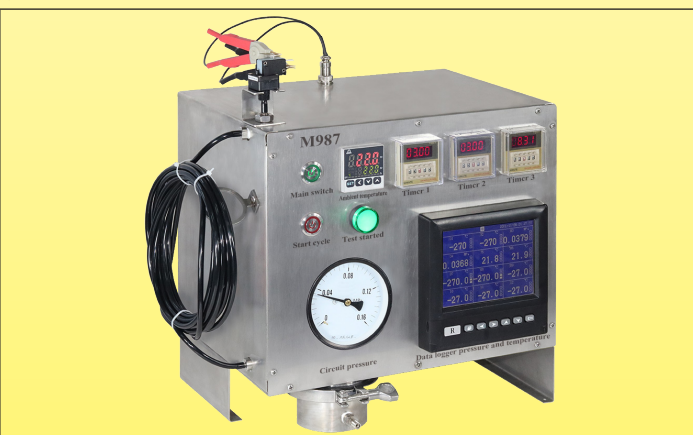
根据推动按钮的体积及其产生的压力反复不断地测量空气开关连接管的最大长度的测试设备 (Ultimheat 实验室)
